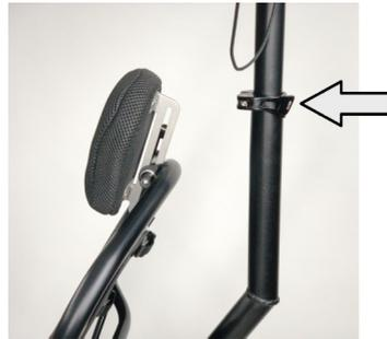
An der Klemmvorrichtung auf dem Trike-Hauptrohr ist ein Schnellspanner für die Winkelverstellung der vorderen Stütze.
