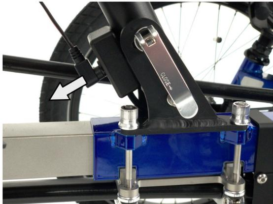
Öffnen Sie den Schnellspanner an der Winkelverstellung der vorderen Stütze.
