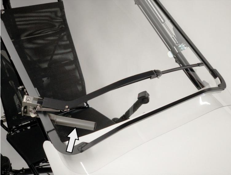
Der Scheibenwischer wird mit dem innenliegenden Hebel (Pfeil im Bild) von Hand betätigt.
