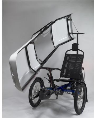
Zum Einsteigen öffnen Sie die Haube durch Betätigen des Öffnerhebels auf der linken Seite (unter der vorderen Abdeckung, Pfeil im Bild). Klappen Sie die Haube nach rechts zur Seite, bis sie durch die Fangleine gehalten wird.
